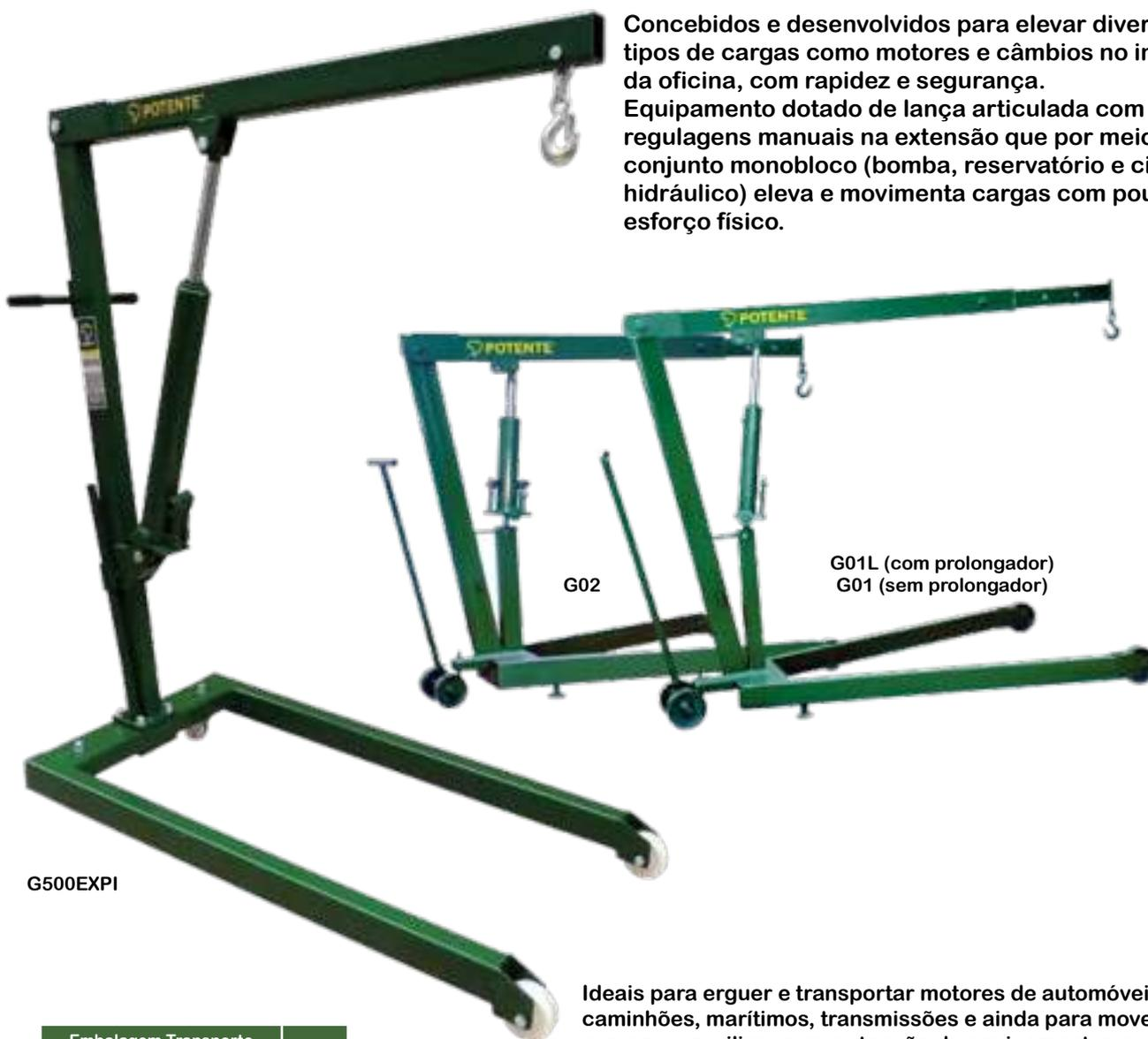
Concebidos e desenvolvidos para elevar diversos tipos de cargas como motores e câmbios no interior da oficina, com rapidez e segurança. Equipamento dotado de lança articulada com duas regulagens manuais na extensão que por meio de um conjunto monobloco (bomba, reservatório e cilindro hidráulico) eleva e movimenta cargas com pouco esforço físico.
