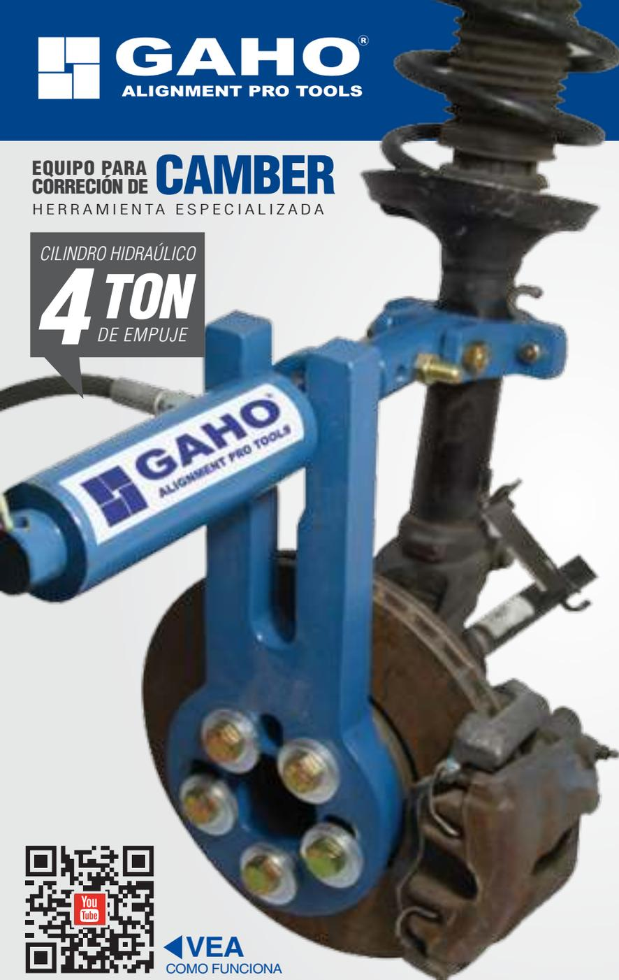
✓ El GH-900 es una herramienta KIT para corrección de los ángulos de inclinación camber en vehículos con suspensión tipo McPherson.
