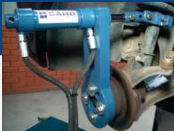
**HAGA CORRECCIONES DE CAMBER DE HASTA 1° SIN DESARMAR EL EJE, CALENTAR PIEZAS O DAÑAR ELAMORTIGUADOR**
